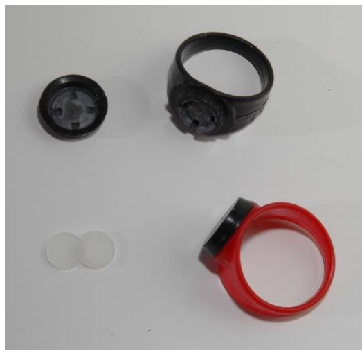
Obr. 3: Prstový termoluminiscenční dozimetr NUVIA (PTLD)
